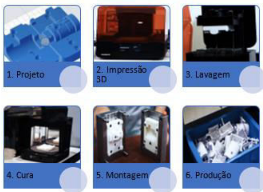
Figura 2 - Fluxograma de produção de inserto molde por manufatura aditiva.
