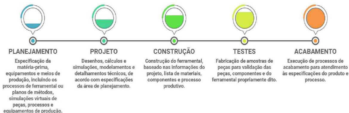
Figura 14 - As cinco fases de desenvolvimento de ferramental (ROTA 2030, 2022)
